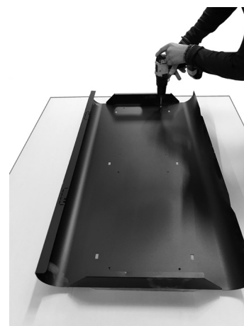
Fig. 51 - Enrosque el acabado en el lateral
