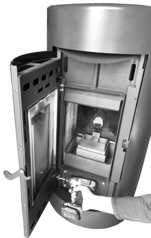
Fig. 64 - Desmontaje de la puerta
