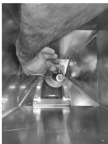
Fig. 81 - Extracción de la espiral
