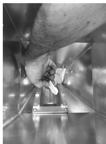
Fig. 82 - Extracción del cojinete
