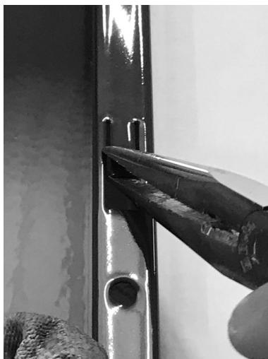
Fig. 46 - Pliegue las lengüetas
